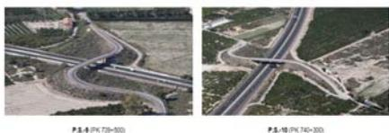
Los trabajos responden a la necesidad de realizar la ampliación de la A-7 con el diseño de un tercer carril de circulación en ambos sentidos
